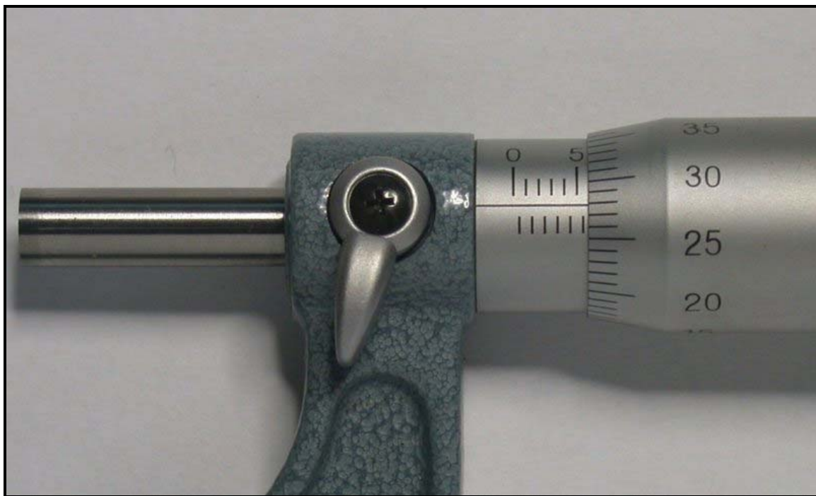
Foto de um micrômetro fornecendo uma leitura de 5.78 mm
