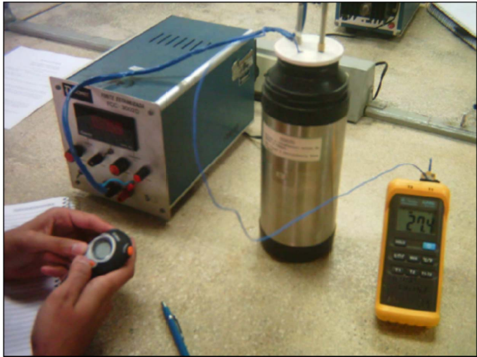
Figura 4.2.1: Montagem experimental. Pode-se ver a fonte de energia para o aquecedor, o calorímetro, o termômetro e o cronômetro nas mãos do operador.
