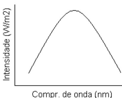
Figura 1. Dependência da intensidade com o comprimento de onda para o LED de germânio que emite luz na cor azul
