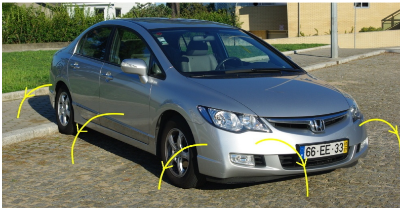
Figura 7.7.: Um carro é um condutor isolado. As linhas de campo são perpendiculares à superfície da carroçaria e ao chão.
