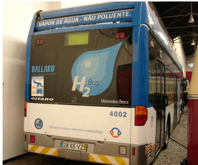
Figura 4.8.: Autocarro experimental a hidrogénio da STCP no Porto.
