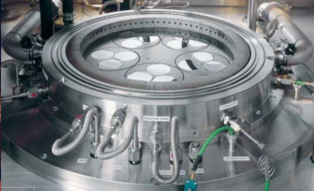
Reactores Aixtron para a investigação (esquerda) e para a produção, com precisão atómica, de películas finas de semicondutores compostos (direita).
