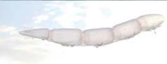
O "Luftwurm" ("verme aéreo") da Universidade de Estugarda, previsto como estação de ligação (relais) de radiotelefonia.
