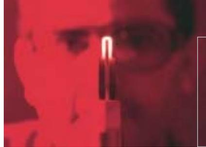
A Natureza não consegue fazer isto: aplicar negro de fumo nanoscópico a cerâmica, para isqueiros resistentes à corrosão, como os dos esquentadores a gás. A condutividade ajustável da cerâmica evita o recurso a transformadores.
