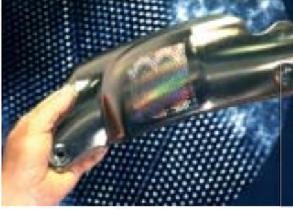
O Institut für Neue Materialien (INM – Instituto de Novos Materiais), de Saarbrücken, desenvolveu métodos com nanopartículas, para aplicar em peças de metal hologramas resistentes à falsificação e ao desgaste.
