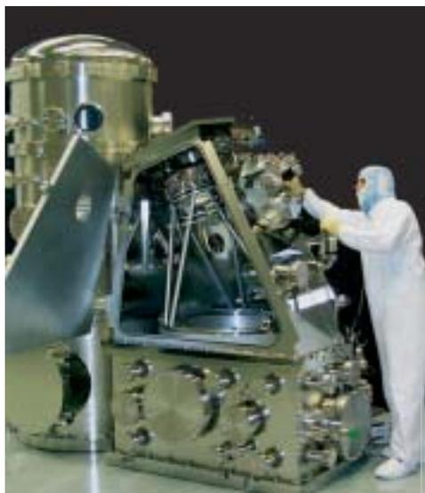
Protótipo da instalação de um alinhador EUV para a produção das futuras gerações de chips.
