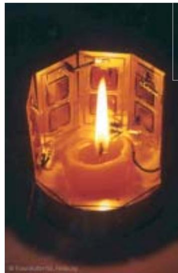
A luz da vela é suficiente para as células termofotovoltaicas accionarem um aparelho de rádio.
